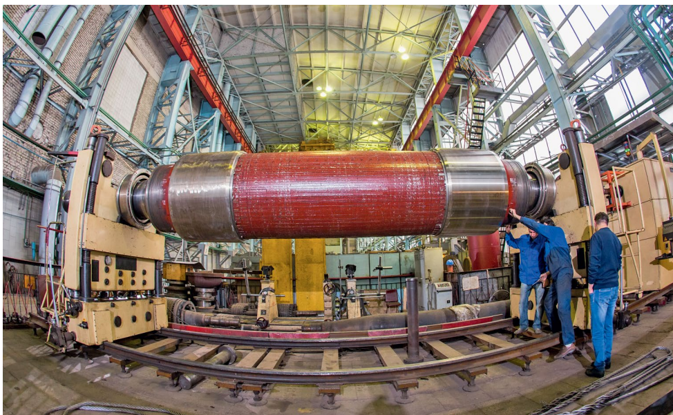
Установленный на ЦРМЗ станок ВМ-36000 используется для балансировки роторов массой до 40 т
